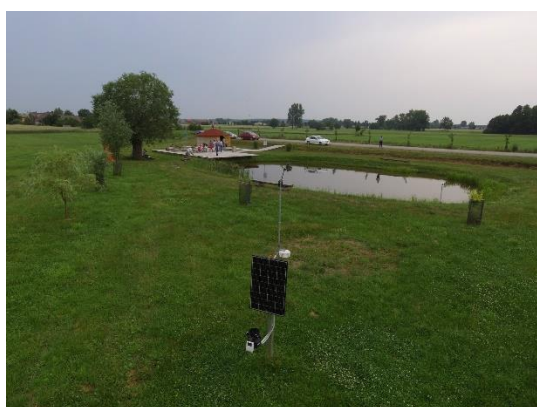
Ryc. 5 – 6. Stacja meteorologiczna z instalacją czujnika pomiaru temperatury wody
