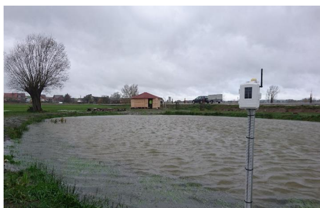
Ryc. 5 – 6. Stacja meteorologiczna z instalacją czujnika pomiaru temperatury wody
